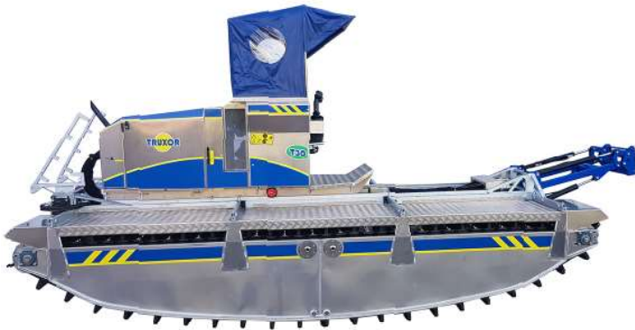
Гидравлический привод перемещения кабины для распределения веса для поднимания тяжелых грузов при работе на воде
