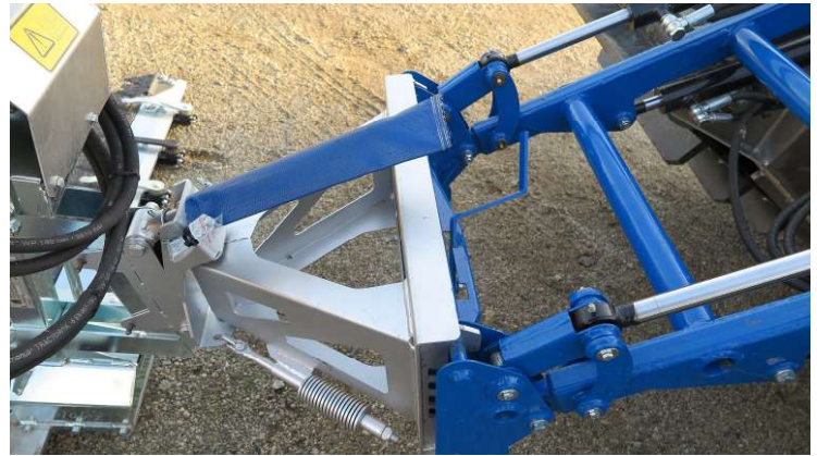
Передний манипулятор с функцией параллельного подъема и полуавтоматическим захватом X4 для быстрой смены навесного оборудования
