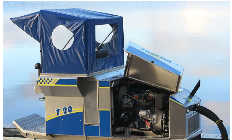
Удобный доступ к двигателю для проведения технического обслуживания
